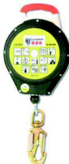
R10 DISPOSITIVO ANTICADUTA A FUNE Con riavvolgimento automatico Assorbitore di energia Omologato per utilizzo in verticale e orizzontale Fune metallica diametro 4 mm lunghezza 10 m Gancio girevole apertura mm.21 Carcassa in ABS Dimensioni 208x85x280 mm Peso kg 5,3
