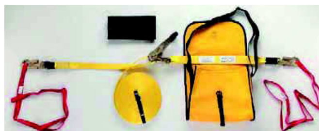
1141/49 LINEA VITA TEMPORANEA PER 3 PERSONE Nastro con tensionatore lunghezza 20 metri Fetture di ancoraggio Moschettoni girevoli - Borsa con tracolla Distanza massima di flessione 5,4 metri
