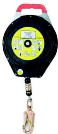
R20 DISPOSITIVO ANTICADUTA A FUNE Con riavvolgimento automatico Assorbitore di energia Omologato per utilizzo in verticale e orizzontale Fune metallica diametro 4 mm Lunghezza 18 m Gancio girevole apertura mm. 21 Carcassa in ABS Dimensioni 260x120x340 mm Peso kg 11
